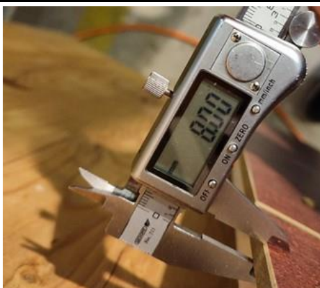
Abbildung 2: Verifizierung der Schichtdicke.
