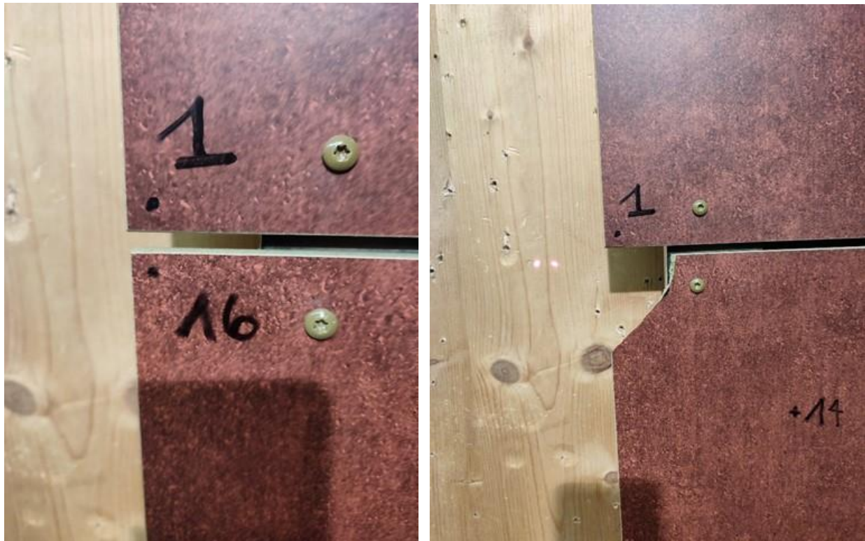
Abbildung 4: Der Schuss mit einer 40 mm Eiskugel führte zum Abbruch einer Ecke. Der Schuss besass jedoch eine zu hohe Energie und wurde an einer gleichwertigen Stelle wiederholt.
