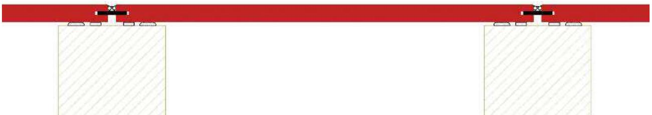
Balkonbodenplatte auf Holztram verdeckt befestigt (geklebt)
