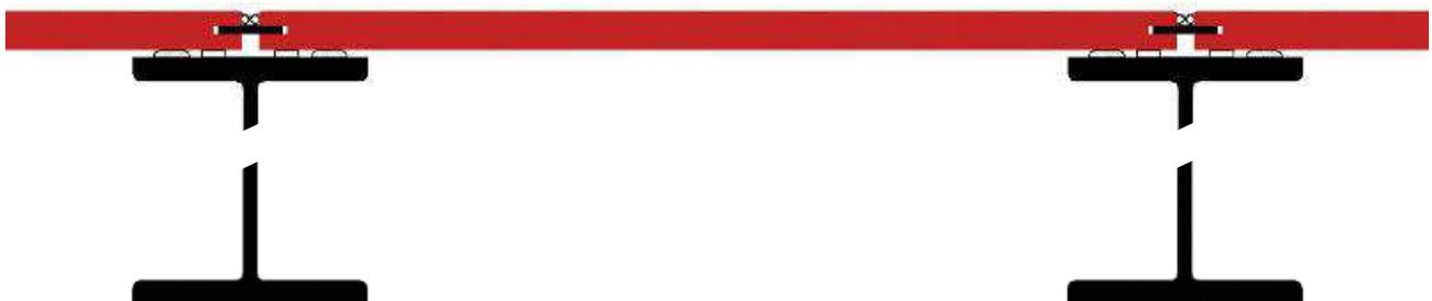
Balkonbodenplatte auf Stahlträger verdeckt befestigt (geklebt)
