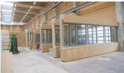
Die Fenster werden bereits in der Fertigung in die Wandelemente eingebaut. Der Grundputz wird ebenfalls bereits in der Fertigung aufgetragen.
