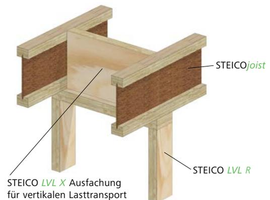
**F5 Weiterleitung hoher Einzellasten durch die Deckenebene**
