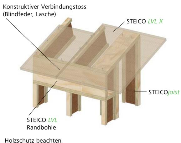
**D12 Aufdachdämmung – Aufdoppelung mit STEICOjoist**
