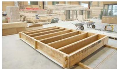
STEICO<sup>wall</sup> Stegträger bilden das Tragwerk der Wände. Der Elementrahmen besteht aus STEICO <sup>LVL R</sup>.
