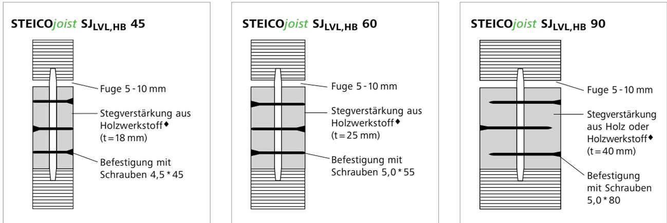
♦ Holzwerkstoff: STEICO LVL X | OSB/3 | geeignetes Sperrholz
