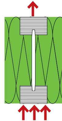
Prinzip der vergleichbaren Vollholzbreiten. Statt eines Stegträgers wird ein deutlich schmalerer Vollholzquerschnitt bemessen ( $b_{vergl.}$ ).
