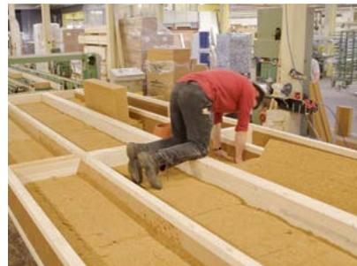
Dank Verwendung vorgedämmter Träger können die Gefache auf einfache Weise mit STEICOflex Mattendämmstoff gefüllt werden.
