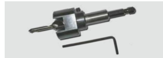
Bohrer inkl. Senker und integriertem kugelgelagerten Tiefenstopp, der Beschädigungen an der Diele verhindert. Für Schrauben mit einem Ø von 4,5–5,0 mm.
