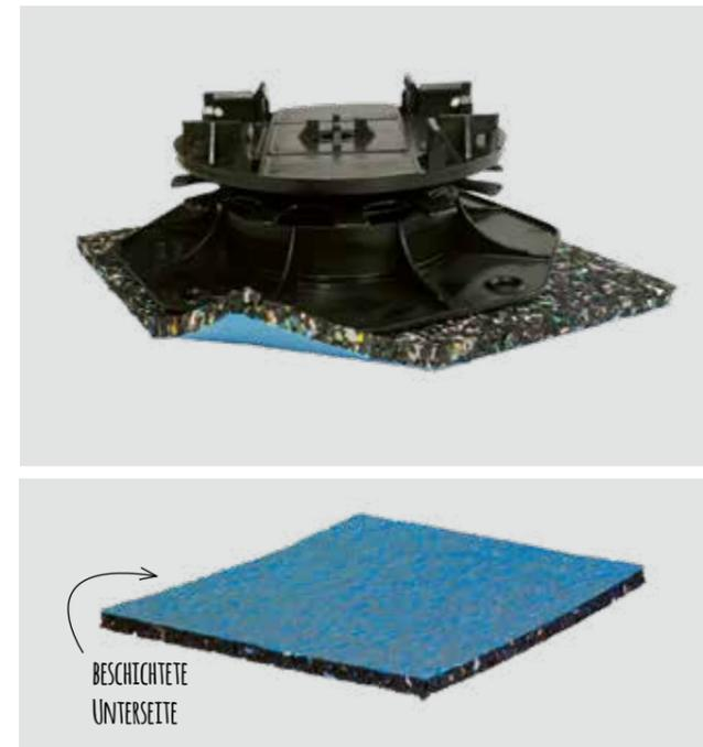
Ein langlebiger und widerstandsfähiger Schutz vor druck- oder stossartigen Belastungen auf hochwertigen Abdichtungen wie Dachfolien oder Balkonabdichtungen. Das 3-Schicht-Verbundfoliensystem auf der Isopad-Unterseite dient als integrierte Trennbarriere bei PVC-Abdichtungen, damit keine Unverträglichkeit (Weichmacherwanderung) der Materialien auftreten kann. Zudem ist das Isopad durch seine Beschichtung noch strapazierfähiger und reissfester.
