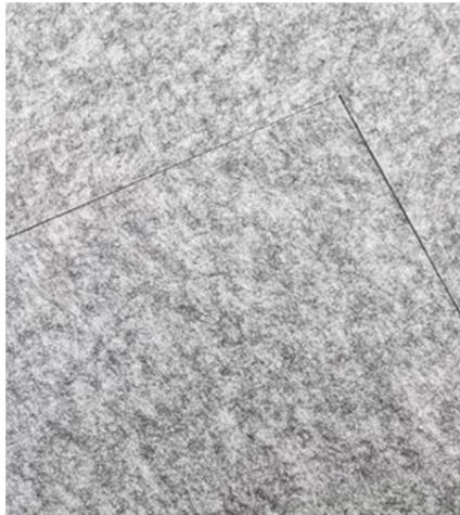
aPerf® kann mit einer Plattensäge zugeschnitten werden.
