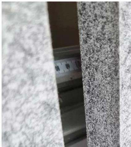
Beispiel einer zugeschnittenen Platte durch eine Plattensäge.
