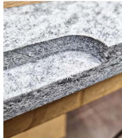
Dieser abgesetzte Falz wurde mit einem Oberfräser hergestellt.
